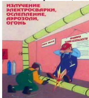
Рисунок 8. Излучения электросварки, ослепление, аэрозоли, огонь
