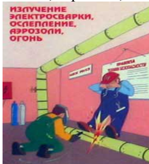
Рисунок 8. Излучения электросварки, ослепление, аэрозоли, огонь
