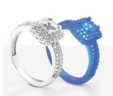
Слева – Кольцо из металла; Справа – 3d модель из пластика
